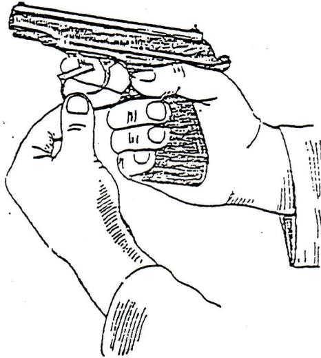
3. Снять со ствола возвратную пружину.
