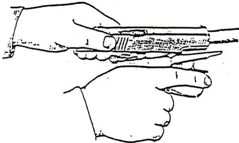
4. Сборку пистолета после неполной разборки производить в обратном порядке.
